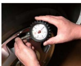
車を使わなくても、空気圧は変化します。まずはタイヤが地面に接している部分が異状にたわんでいないかどうかを調べましょう。空気圧が不足していると走行時の安定性や燃費が悪くなるほか、ハンド操作が重くなります。またタイヤゲージがあれば、より正確に点検できます。
