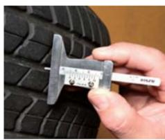
リップを起しやすくなり大変危険です。一部でもスリップサインが現れたら、車検が通りません。特に雨の日は危険な状態です。タイヤ交換のサインと覚えておいてください。なお、デプスゲージで計れば、残溝の深さが分かります。
