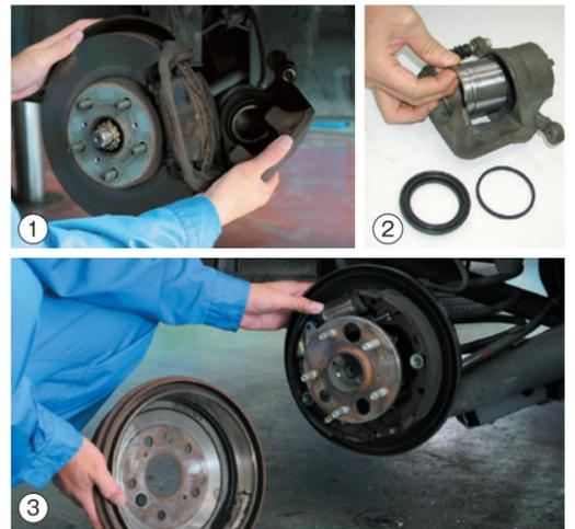
①ブレーキパッド…ディスク摩耗、損傷をチェック。②キャリパー…液漏れ、損傷、ブレーキパッドの摩耗をチェック。液漏れがある時は、ホイールシリンダを分解し、シール類のゴム部品を交換します。③ブレーキドラム…車から外して、シューの摺動部分、ライニングの摩耗をチェック。
